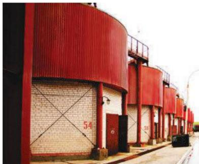
Серийно изготавливаются сгустители Ø 10м и Ø 18м, возможно изготовление сгустителей других размеров. Сгустители Ø 18м применяются в качестве сгустителей глинисто-солевого шлама в производстве флотационного и галургического KCl.
