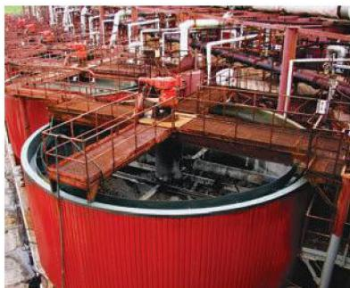
Высокопроизводительные компактные сгустители могут быть использованы для сгущения (обезвоживания) и осветления в качестве гидросепараторов, хвостовых сгустителей в горнорудной и химической промышленности, для очистки сточных вод. В настоящее время они нашли широкое применение в калийной промышленности для сгущения шламового и солевого продукта с получением осветленного маточного раствора. Эксплуатируются гидросепараторы и хвостовые сгустители Ø 18м.
