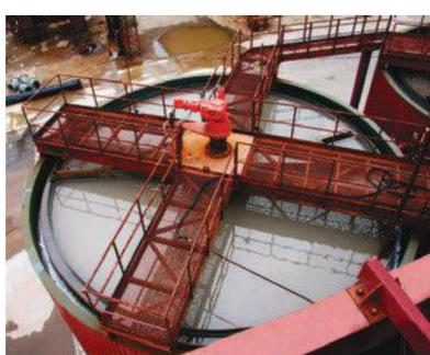
Для сгустителей, работающих на флотационных пульпах (характеризуются определенным воздухосодержанием и остаточным содержанием реагентов), предусматривается система съема пены пеносъемниками в пеноприемник и удаление из процесса.
