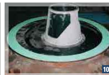
9 Montaggio gruppi testata/cono distributore sabbato e rivestito con composito ceramico. Assembly of end shield and port plate sandblasted and covered with ceramic composite.
