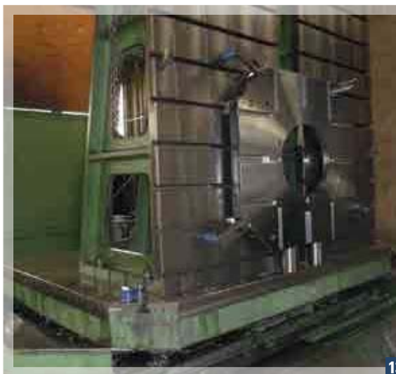
9/10/11/12/13/14 Piastra per stampi produzione cerchi in lega settore automotive. Plate for mould - alloy wheels production for automotive sector.
