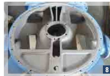
8 Testata sabbata. Sandblasted end shield.
