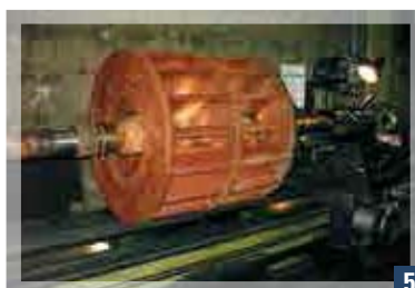
5 Lavorazione girante al tornio parallelo. Impeller machining with the parallel lathe.
