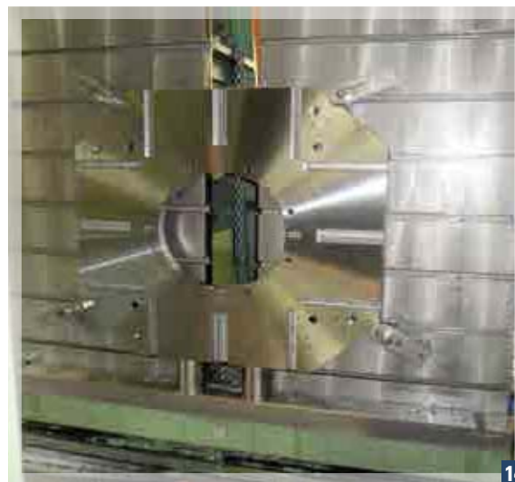
9/10/11/12/13/14 Piastra per stampi produzione cerchi in lega settore automotive. Plate for mould - alloy wheels production for automotive sector.
