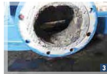
3 Particolare incrostato della testata. Particular of the encrusted head.
