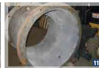
11 Corpo pompa sabbato e rivestito con materiale ceramico. Pump casing sandblasted and covered with ceramic composite.
