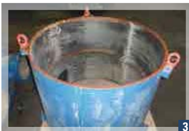
3 Corpo pompa da sostituire. Casing to be replaced.
