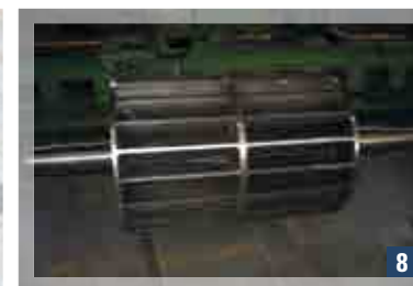
8 Nuovo gruppo girante/valbero. New impeller+shaft group.
