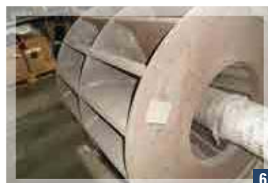
6 Girante dopo la sabbatura. After-blasting impeller.
