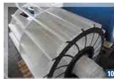
10 Girante sabbata e rivestita con composito ceramico. Sandblasted impeller and covered with ceramic composite.
