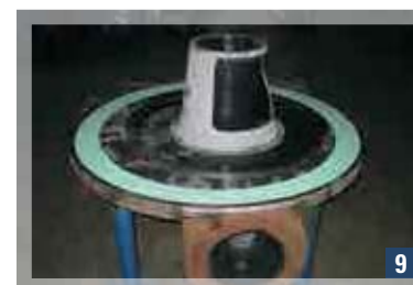
9 Montaggio gruppi testata/cono distributore sabbato e rivestito con composito ceramico. Assembly of end shield and port plate sandblasted and covered with ceramic composite.
