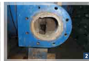
2 Particolare incrostazioni testata. Particular of the encrusted head.
