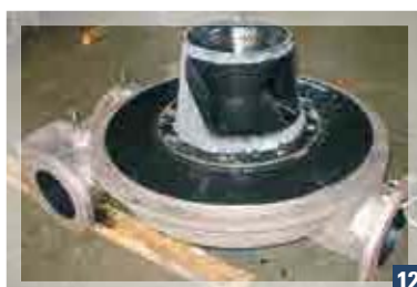
12 Rimontaggio gruppo testata distributore rivestiti. Assembly of covered port plates + end shields.
