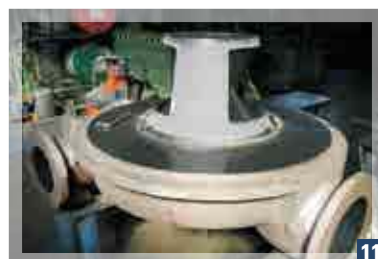
11 Rimontaggio gruppo testata distributore rivestiti. Assembly of covered port plates + end shields.
