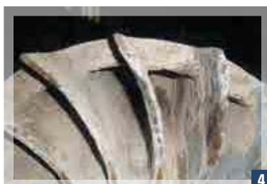
4 Girante da sostituire. Impeller to be replaced.
