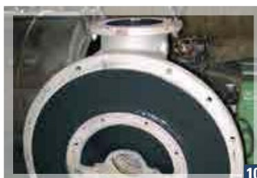
10 Testata rivestita con materiale ceramico. End shield covered with ceramic composite.
