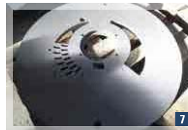
7 Disco distributore sabbato. Sandblasted port plate.
