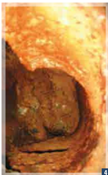
4 Particolare incrostato delle testate. Particular of the encrusted end shields.
