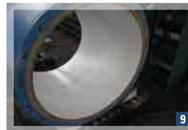
9 Corpo pompa sabbato e rivestito con speciale vernice protettiva. / Sandblasted pump casing and covered with protective paint.
