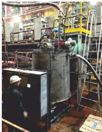
ОАО «Беларуськалий» СОФ-1: установка флотационная опытная
